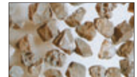
KA bzw. ..Z = Zirkonkorund sehr hohe mechanische Festigkeit
